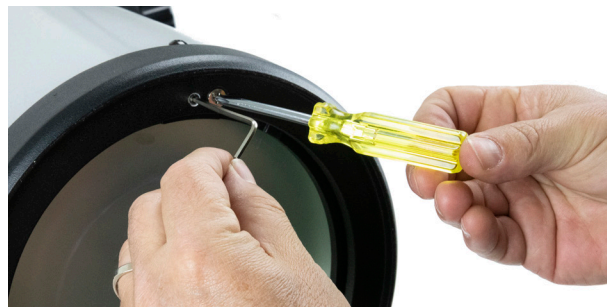
Abbildung 20: Beim 8"-Dob befinden sich in der Spiegelzelle drei Sätze von Push-Pull-Schrauben, mit denen die Neigung des Hauptspiegels eingestellt wird. Lösen Sie eine Schraube des Paares und ziehen Sie die andere fest, um die Neigung einzustellen.
