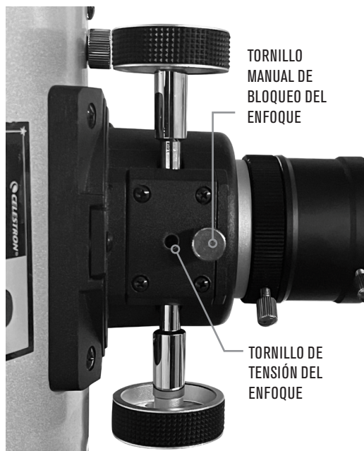
Figura 5: El tornillo de bloqueo del enfoque bloquea en posición el enfoque cuando se haya conseguido enfocar. El tornillo de tensión de enfoque
