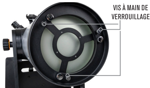
Figure 21: Pour le Dob de 10", il se trouve trois vis de serrage à ressort qui règlent l'inclinaison du miroir principal. Les trois autres vis à main verrouillent le miroir en place une fois les réglages d'inclinaison terminés.
