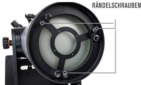
Abbildung 21: Beim 10"-Dob gibt es drei federgelagerte Kollimationsschrauben, mit denen die Neigung des Hauptspiegels angepasst wird. Die anderen drei Rändelschrauben fixieren den Spiegel, sobald die Neigungsanpassung abgeschlossen ist.
