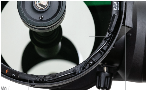
Abb. 8 Stromversorgungsbuchse Aufbewahrungsclips Thermistor-Buchse Aufbewahrungsclips
