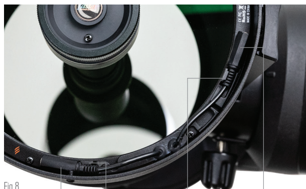
Fig 8 Connettore alimentazione Fermo Fermo Connettore termistore
