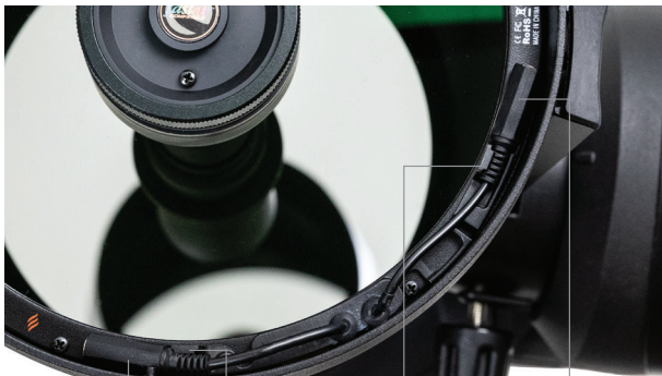
Fig. 8 Toma de alimentación Clip de almacenamiento Clip de almacenamiento Toma de termistor
