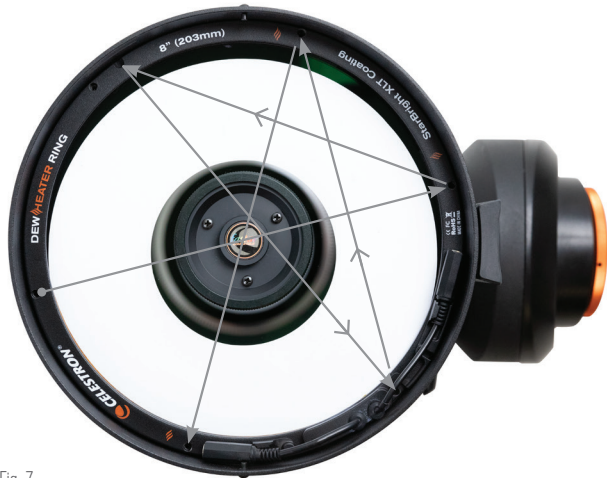
Fig. 7 Apriete alternamente los tornillos con un patrón en cruz del modo indicado.
