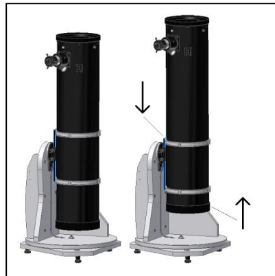
Gráfico B. ¡Mover la cola de milano hacia abajo y el tubo hacia arriba!
