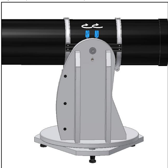
Figure 18. Faites glisser la queue d'aronde du télescope puis serrez fermement les deux molettes.
