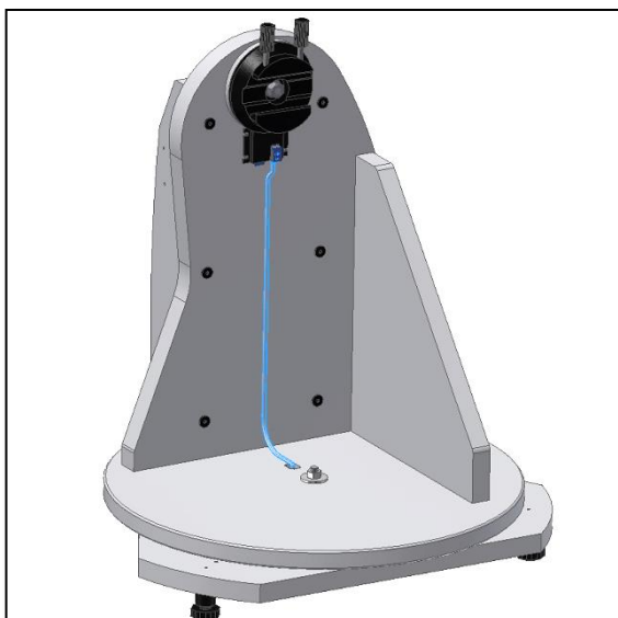
Figure 15. Raccordez le câble fourni (pièce 4). Vous entendez un « clic » lorsque les prises sont correctement raccordées.
