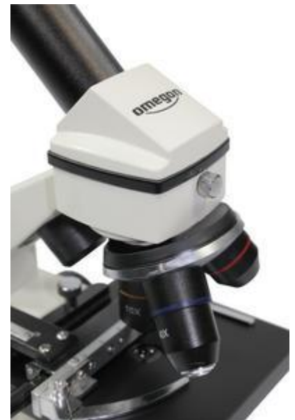
La tourelle revolver avec les objectifs
